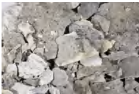
写真 10：採取した外装塗材
