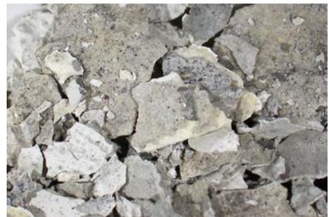
写真 10：採取した外装塗材
