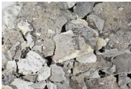
写真 10：採取した外装塗材
