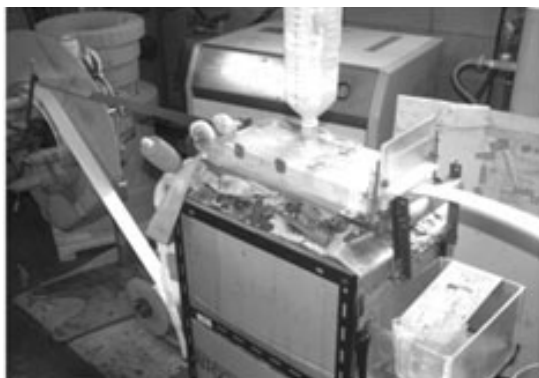
↑化粧品キャップ製造工場では、ペットボトルを利用して油の自動供給装置を考案。《低コスト賞》
