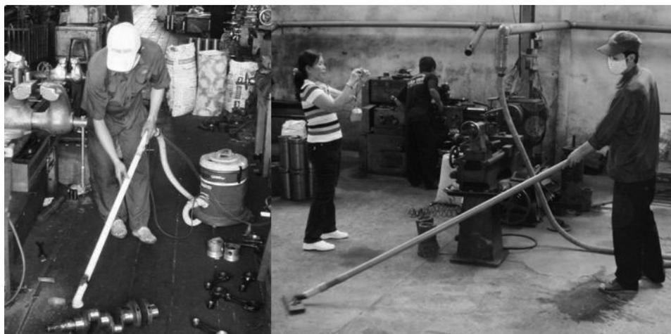
1月にベトナムに訪問したときのピストン製造工場の改善事例です。旋盤加工場で電気掃除機を使っていました。掃除機の先はハンドメイド、ホースは集塵機へとつながっています。床に積もった粉じんの再発じんを予防する低コスト対策でした。
